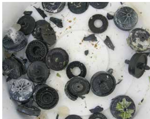
Gocciolatoi occlusi da materiale di origine minerale e da sostanza organica, che sono stati smontati da un impianto di microirrigazione.
